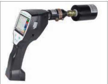
干燥容器可保护传感器，实现快速的适应时间
