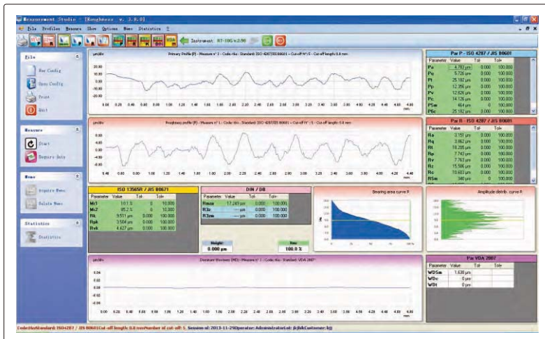
测量软件(选配), 可通过软件控制粗糙度仪, 可显示粗糙度测量值、轮廓图形和曲线, 带数据统计分析功能
