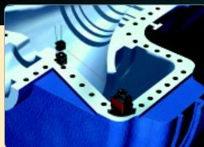
B. 用 D22 ( 选项 ) 测量透平剖分面的平面度
