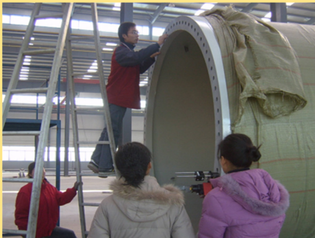
塔架法兰出厂检测
