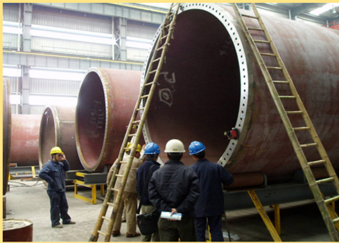
塔架法兰预装检测
