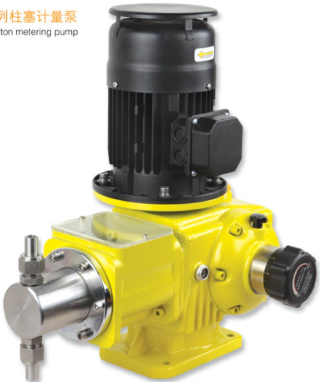
HZ 系列柱塞计量泵是我公司开发的具有国际先进水平的柱塞式计量泵，产品结构先进、外形美观、运行稳定，柱塞计量泵通过柱塞的往复运动配合进出口单向阀直接将工作介质吸入和排出。在柱塞和密封都是接触介质的情况下，选择合适的柱塞材
