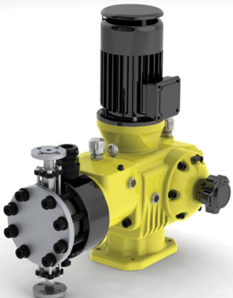
泵的液力端和隔膜组成工作腔，由活塞驱动的液压油均匀作用于隔膜做周期性变形从而驱动隔膜做往复运动的计量泵，叫液压隔膜计量泵。
