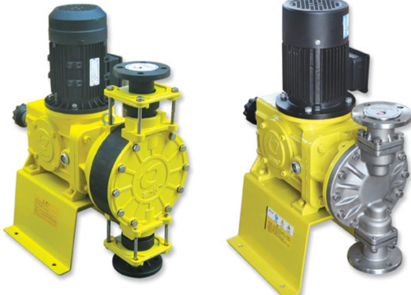
机械隔膜计量泵是由泵头、隔膜（膜片）组成的工作腔，由减速机构带动的隔膜形成的周期性的容积变化，及往复频率（冲次）来实现流量输送的可动态、静态精确调节流量的容积泵。
