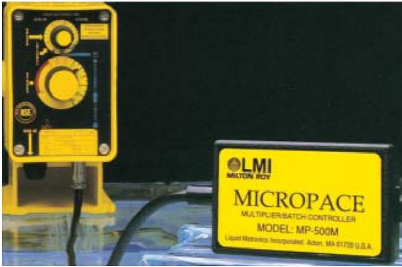
MP-100 模拟 / 数字转换器、MP-400D 四位除法器、MP-500M 四位乘法器及 MP-1000RC 数字式远程控制器, 分别可直接接收 4~20mA 信号, 或乘、除输入的脉冲信号、或直接输出脉冲信号。用于比例式调节米顿罗公司电磁计量泵的输出流量。
