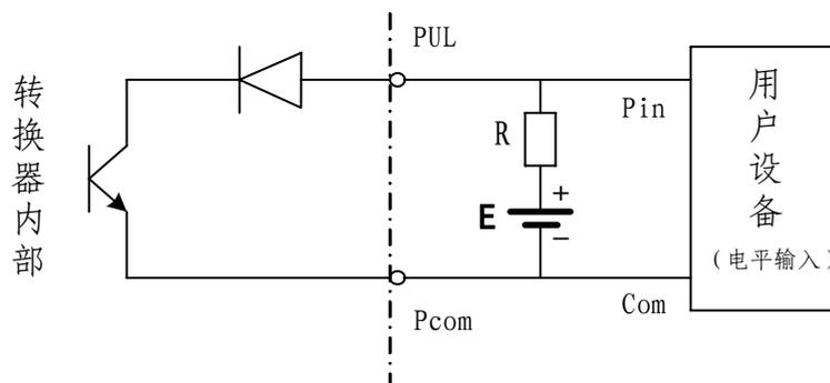
b) 数字量输出接光电耦合器 (如 PLC 等)
