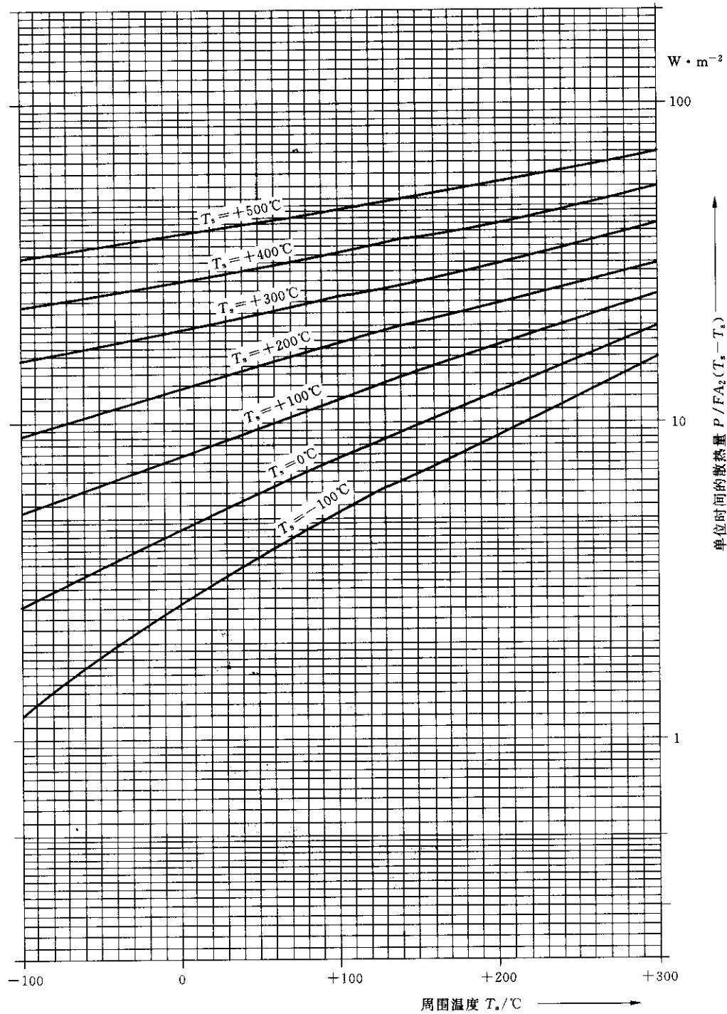
图 E.1 在周围温度  $T_s$  下, 试验样品的表面温度  $T_s$  与单位时间散热量的关系
