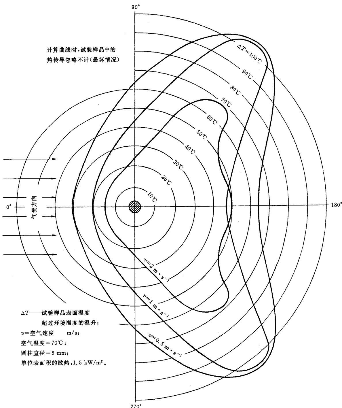
图 B.3 在速度为  $0.5 \text{ m} \cdot \text{s}^{-1}$ 、 $1 \text{ m} \cdot \text{s}^{-1}$  和  $2 \text{ m} \cdot \text{s}^{-1}$  的气流中稳定发热圆柱体周围的温度分布
