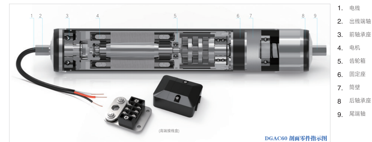
DGAC60 剖面零件指示图
