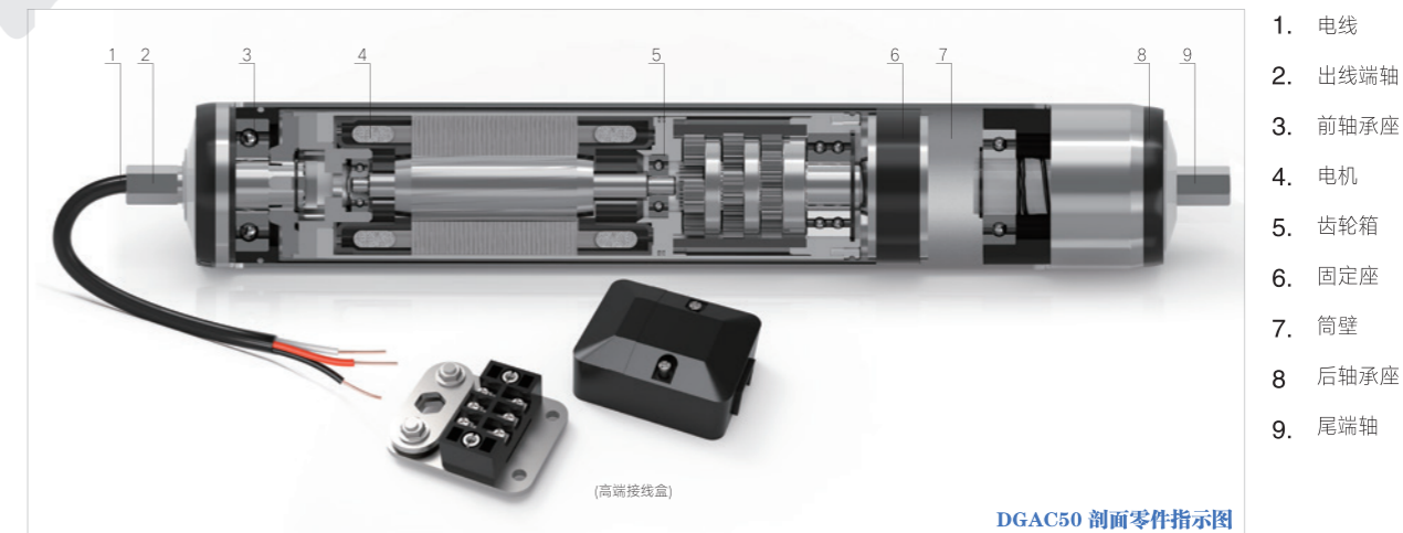
DGAC50 剖面零件指示图
