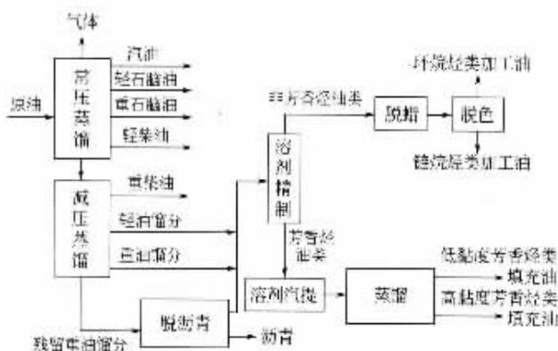
图 5-3 由原油生产石油系列增塑剂的基本过程
