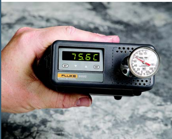
利用手持式干井可方便地进行温度传感器校准
