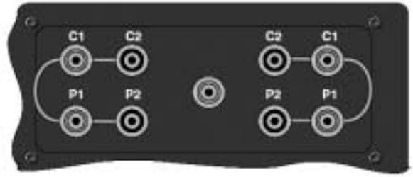
图 50 使用短接导线
