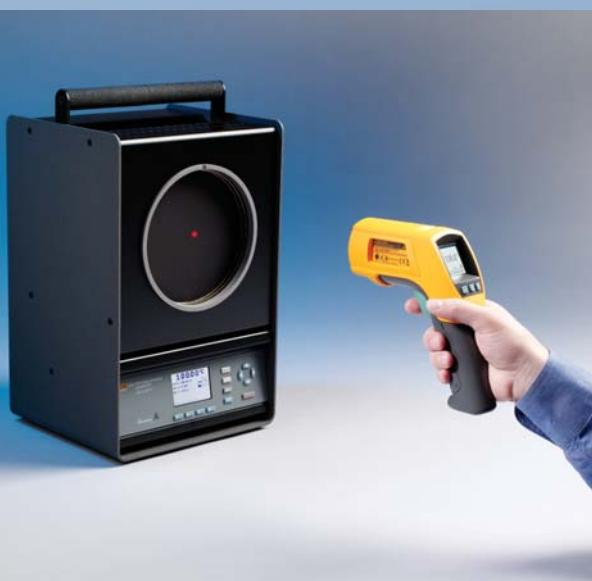
418X 的发射率可补偿修正，调节成与被测温度计发射率相同。
