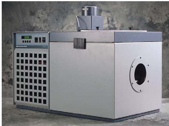
用于检定红外探头的恒温槽
