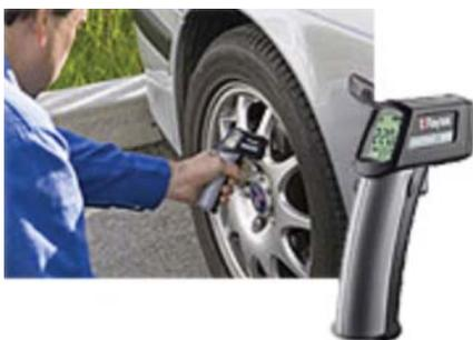
对于这类仪器的检定或者校准，大都是使用黑腔体进行。而目前的黑腔体的面积都很小，一般在 10 公分以内。不论是红外温度计还是热成像仪，其被测量的物体都是一个面，而不是一个点。因此在校准这类仪器时，如果校准源的面积过小就会有相当一部分测试仪所辐射的区域没有在此范围内，因此就会导致测量的误差。而对于热成像仪需要校准多次来覆盖整个成像仪的面积。如图所示，这就使得校准的工作很麻烦。
