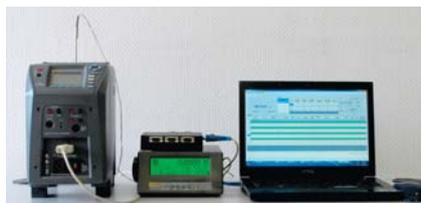
温包检定系统的硬件设备包括福禄克公司的高性能台式恒温槽 7321/7320/7102 或计量炉 9171, 高精度测温仪 1529/1560 以及其他辅助适配器, 可选的夹具等。
