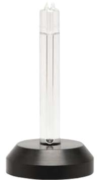
关于水三相点的制作过程可以有手动和自动。手动就是将液氮或干冰慢慢一点一点的倒入瓶子中心孔,逐步的由下至上的冻制。冻制过程中,需要在瓶子中产生冰,但是冰又不能膨胀至瓶子的壁,否则可能会由于冰体的膨胀导致瓶子爆裂。因此手工冻制的过程还是相对麻烦的。自动的冻制是将水三相点瓶放到零下 5 度左右的温度冷冻,然后通过扰动使瓶子中产生冰水混合物。一般小型的水三相点使用自动的冻制过程,例如福禄克的小型水三相点。而大型水三相点由于瓶子体积太大,从冻制器中取出摇动时容易造成瓶子的破损。
