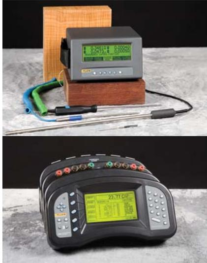
三是选择准确度更高的测温仪表,包括电桥和最新的超级测温仪。这类的仪表通常都超出了新规程的需要。对于电桥而言,价格昂贵的高精度测温电桥可以支持二等以及一等铂电阻测温的要求。但电桥价格相对昂贵,操作复杂,测量的速度很慢。对于这次新规程的要求,并非性能价格比最好的选择。福禄克的超级测温仪采用了最新一代的测温技术,其测温的准确度几乎和电桥相当。但是其操作简单,测量速度快,其性能价格比更高。
