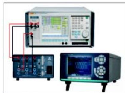
图 3. 利用 Fluke 6105A/6100B 校准 LEM Norma 4000 的一个通道的设置
