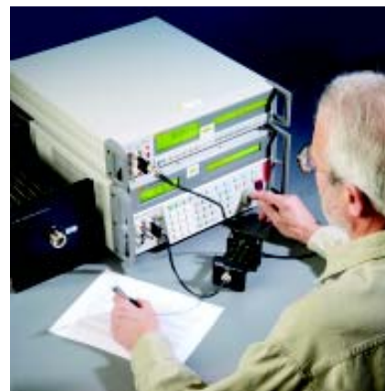
图 5. 用 A40B 校准 5520A 校准器
