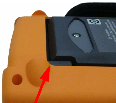
图 8-1 沿箭头所指的方向向前推，即可拆除底座
