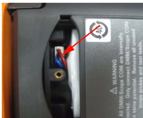
图 8-6 使用镊子拨下三线连接器。
