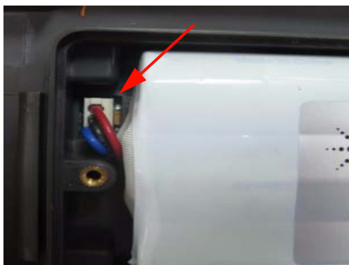
图 8-4 使用镊子从 PCBA 板拔下三线连接器
