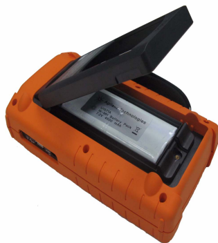
图 8-5 在不拆除底座的情况下拆除电池组
