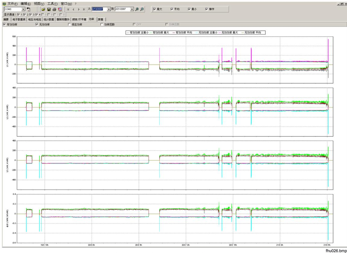
图 11. 选中“有功功率”和“无功功率”时的功率时间图
