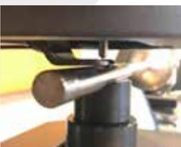
UH4000 多功能系列硬度计独特的夹紧装置可以在硬度测试过程中完美夹持试样。
