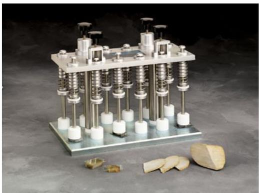
38-1490 PetroBond®薄片粘装置设计用于精确控制样品和玻璃载片之间粘介质的厚度
