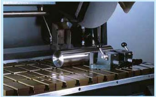
10-2245 和 10-2246 MET-KLAMP VII 左手和右手台钳是适用于大多数应用场合的通用台钳
