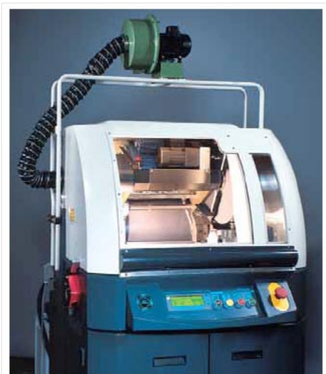
10-2342排烟装置可过滤并减少废气排放
