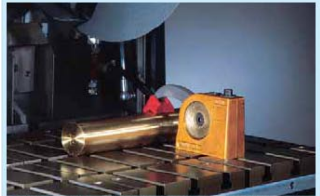
10-3523 快速台钳套件, 用于快速设定和切割外形不规则样品。一系列台钳脚套可供选择
