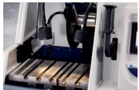
AbrasiMatic300标准配置，不具备X-轴方向移动功能
