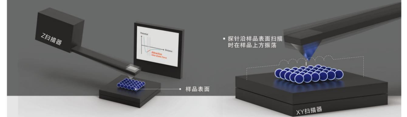
接触模式下，针尖在扫描过程中持续接触样品；轻敲模式下，针尖周期性地接触样品，而在非接触模式下针尖不会接触样品。因此，使用非接触模式具有几个关键优势。由于针尖锐度得以保持，在整个成像过程中会以最高分辨率进行扫描。非接触模式下由于针尖和样品表面可以避免直接接触，避免损坏软样品。
