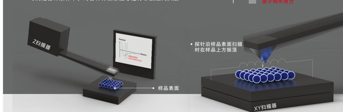
接触模式下，针尖在扫描过程中持续接触样品；轻敲模式下，针尖周期性地接触样品，而在非接触模式下针尖不会接触样品。因此，使用非接触模式具有几个关键优势。由于针尖锐度得以保持，在整个成像过程中会以最高分辨率进行扫描。非接触模式下由于针尖和样品表面可以避免直接接触，避免损坏软样品。
