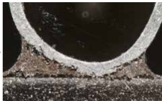
DSX1000 偏光观察 (300X), 清楚呈现焊缝的剥落
