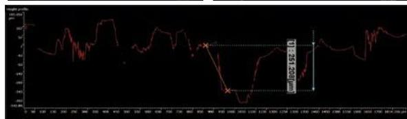
海绵 / 轮廓测量(MPLAPON20XLEXT / 3 × 3 拼接)
