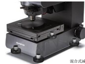
混合式减振机构
