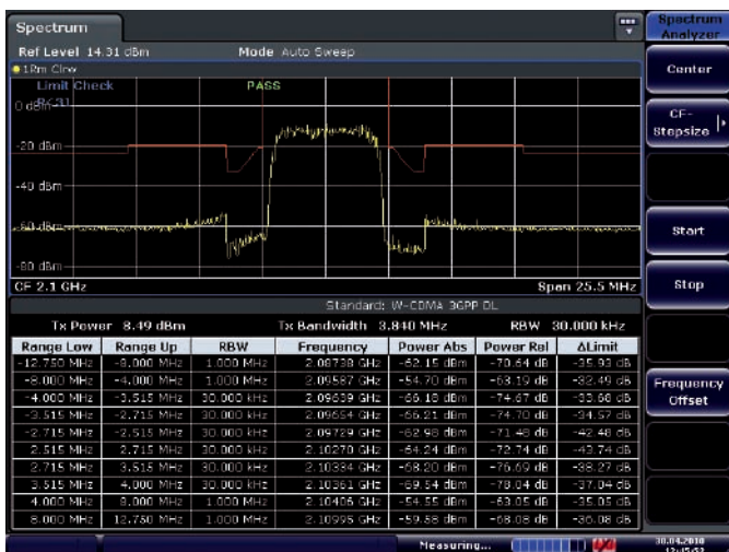
对某3GPP基地的信号进行SEM测量
