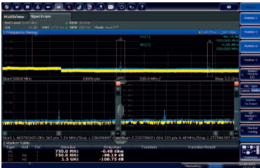
高通滤波器开启（黄色迹线）和关闭（蓝色迹线）时的谐波测量。
