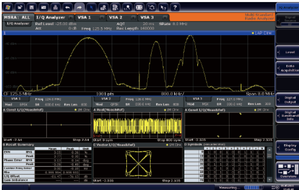
多标准无线电分析仪 (MSRA) : 一次性捕获信号，然后根据不同标准，在不同频率并行分析
