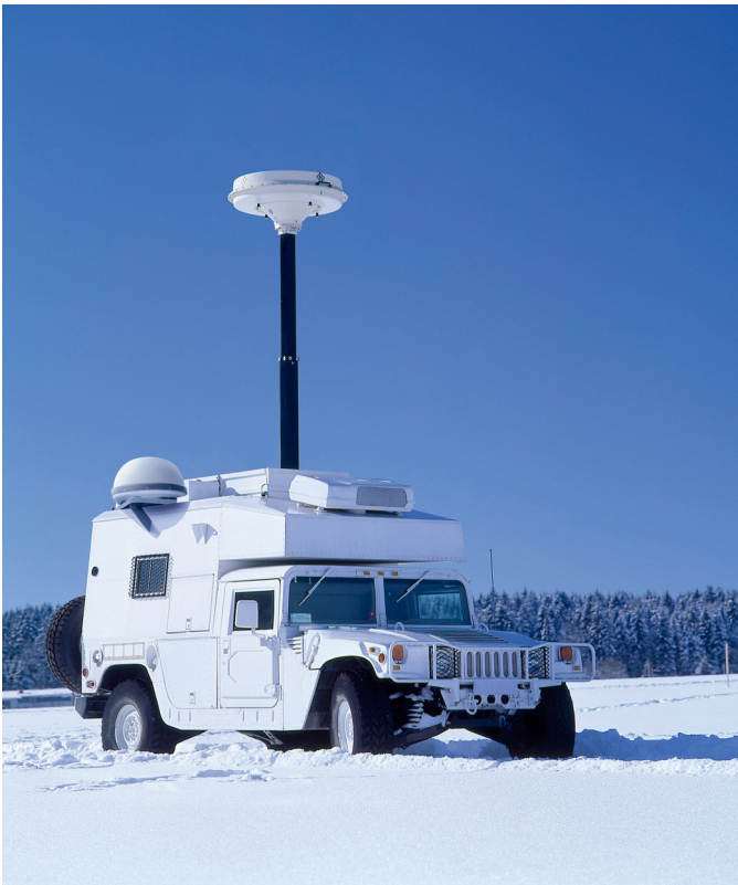
使用R&S®DDF550 和 R&S®ADD253的移动式测向系统。
