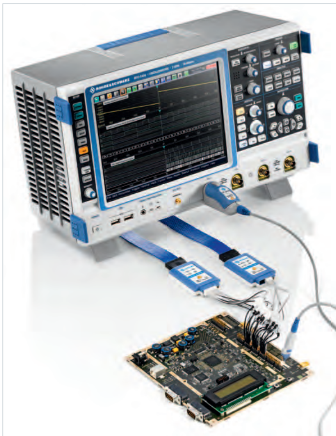
R&S®RTO-B1选项将R&S®RTO示波器转化为混合信号示波器。
