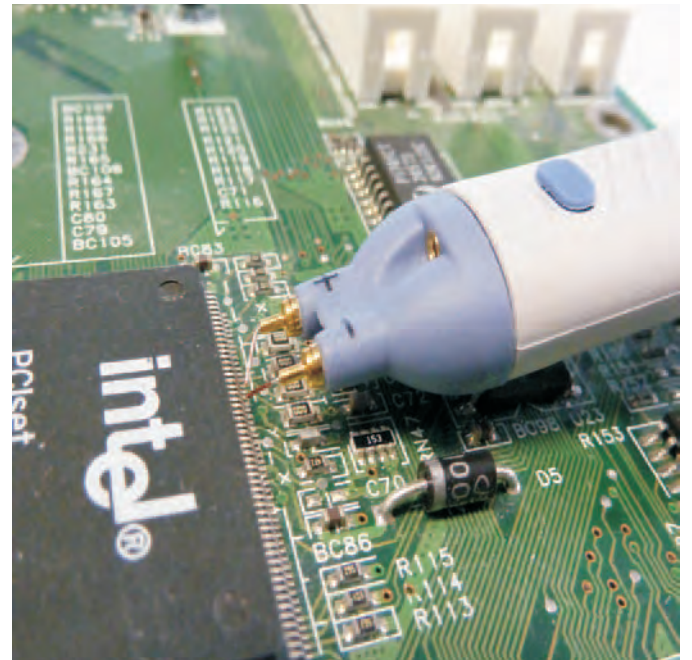
测试高密封装的板上芯片信号
