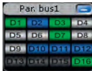
在信号图像中显示数字通道的信号活动，与采集状态无关。
