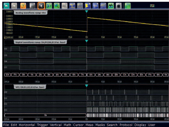
4 位 ADC 斜坡信号用于模拟和数字通道，SPI 总线信号用于数字通道
