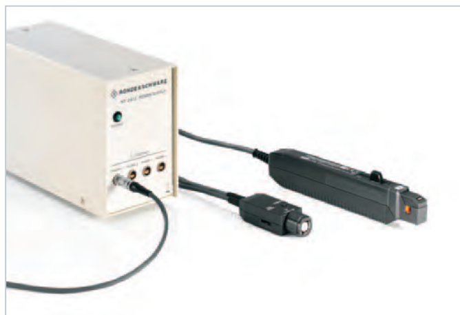
RT-ZC20系列电流探头和专用电源,适合高带宽电流信号测试
