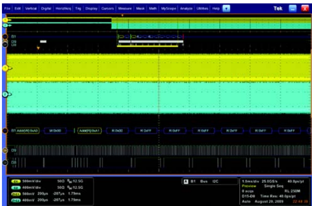
10ms 时长内使用 25GS/s 捕获同步的高速和低速信号
