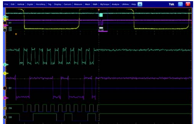
集成的逻辑通道—为系统调试提供时间相关的模拟与逻辑视图
