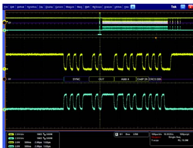
触发 USB 全速串行总线上的特定 OUT 令牌包。总线波形提供了解码后的数据包内容，包括 Start、Sync、PID、Address、End Point、CRC、Data values 和 Stop。
