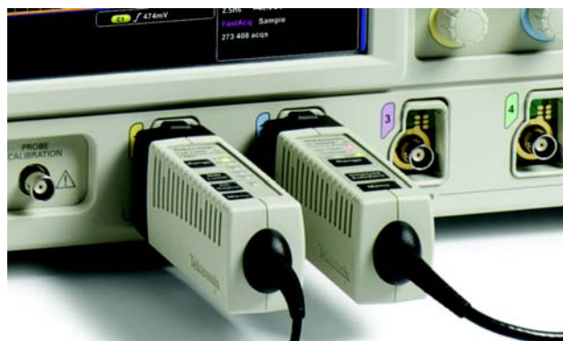
TekVPI 探头接口简化了探头与示波器的连接。
