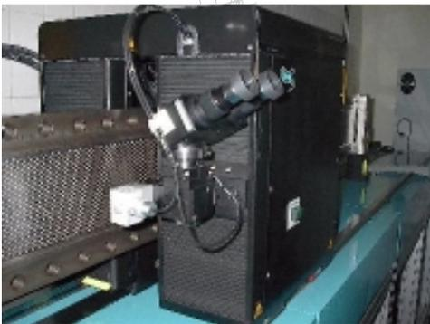
Ein auf präzise geschliffenen Linearführungen mit Zahnriemenantrieb bewegter Portalaufbau wird durch Verwendung eines optischen Linearmesssystems sehr genau positioniert.
