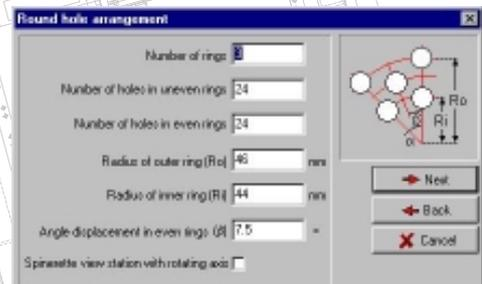
Assistenten gestützte Definition der Spindüsen-geometrie mit anschließender Übersicht.
