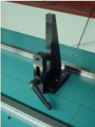
Die Spinddüse wird senkrecht auf zwei Arretierungssäulen aufgestzt.
