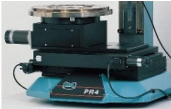
Als Optionen ist ein Drehtisch für Runddüsen erhältlich, deren Durchmesser (max. 405 mm) den Tischhub übersteigt.
