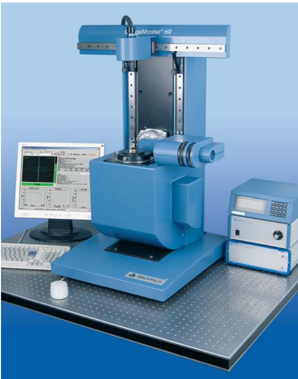
ImageMaster® HR Finite Conjugates Set Up
