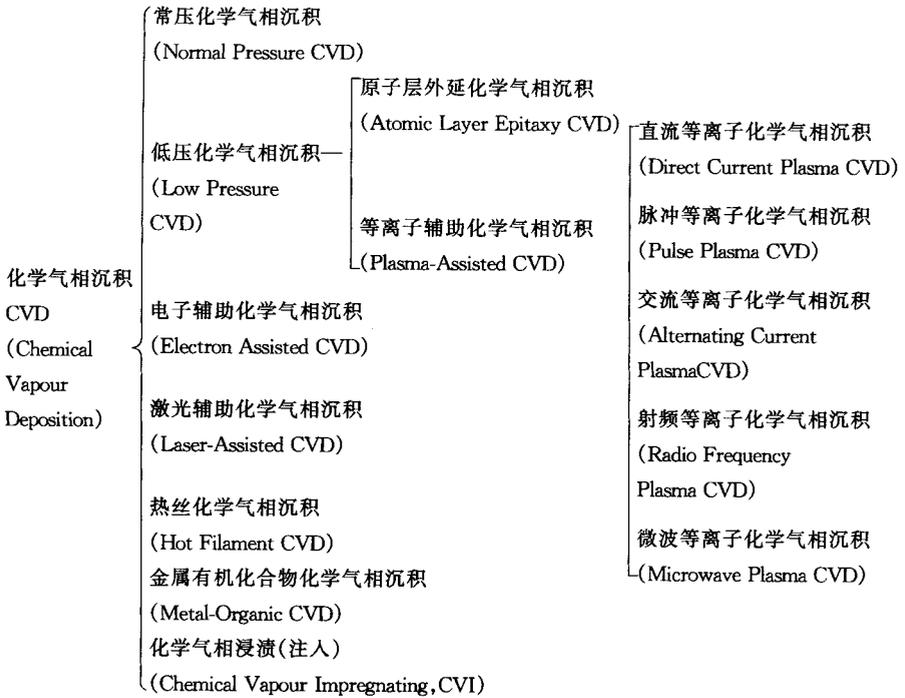
图 1-4-1 基本化学气相沉积方法和等离子体衍生方法
