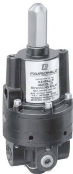
25 型反向继电器提供按输入压力中的增加成正比减少的输出。
