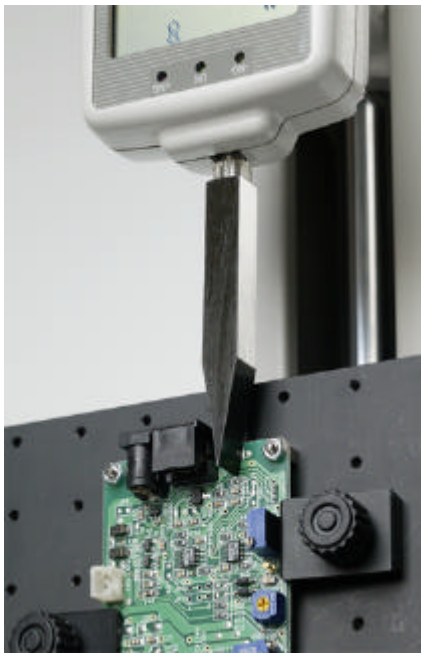
1) チップ部品はんだ継手せん断試験
