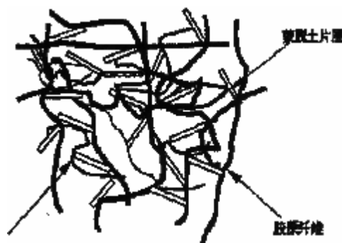
图2 纳米复合黏剂的黏制机理模型
