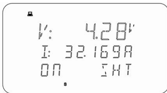
图 5-8 短路测试状态
