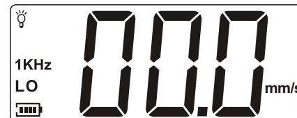
► 再按一下进入位移(D)测量模式“mm”，如下图所示：
