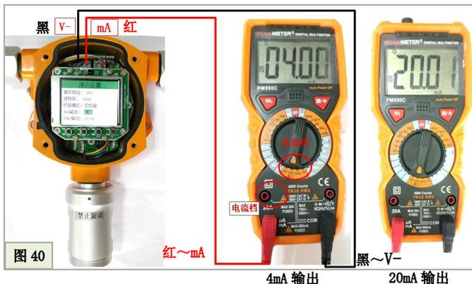
**\*电流表转到直流 mA 档，红表笔插入 mA 孔，红表笔—mA 输出端子，黑表笔—V-\***
