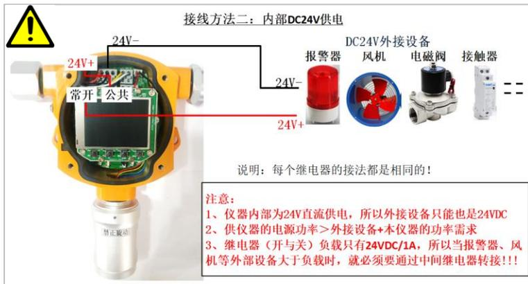
说明：报警点与继电器的对应关系：报警点 1~继电器 1；报警点 2~继电器 2；
