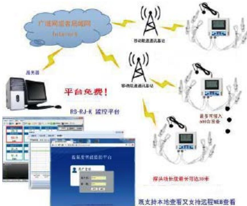
**平台 2:** 环境监控云平台。若T系列温湿度变送记录仪上送数据至本公司的云监控平台，客户无需对产品做任何配置，只需要将设备插上天线及手机卡然后给设备供电即可。
