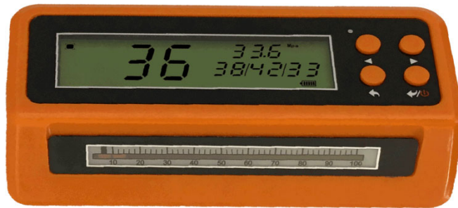
图 3.1 YD225C 型数字回弹仪按键组成
