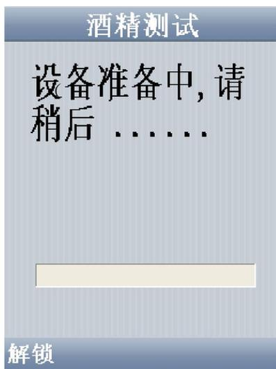
加热的时间长度，与车载酒精测试仪锁在环境温度有关，温度越低所需加热时间越长。清零时间与残留酒精浓度成正比。
