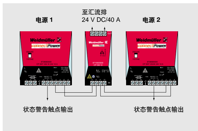
图(4)两台 40A 电源并联
