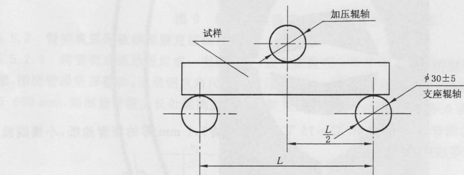
图 12 抗折强度试验机示意图
