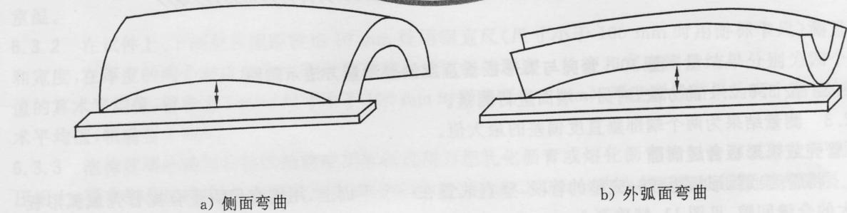
图 8 管壳与弧形板弯曲测量方法示意图
