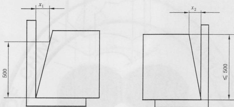
图 9 块与平板垂直度偏差测量方法示意图
