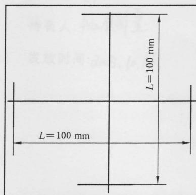
图 13 匀温灼烧线收缩率测点布置示意图
