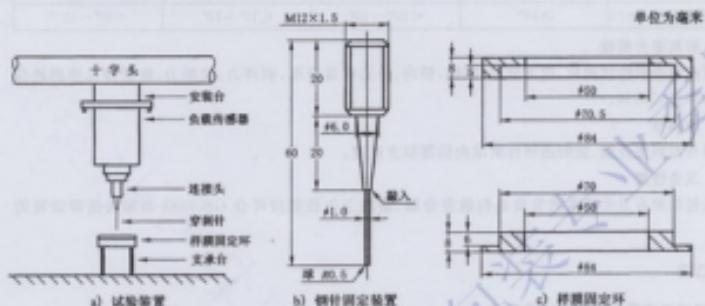
图1 穿刺强度试验装置
