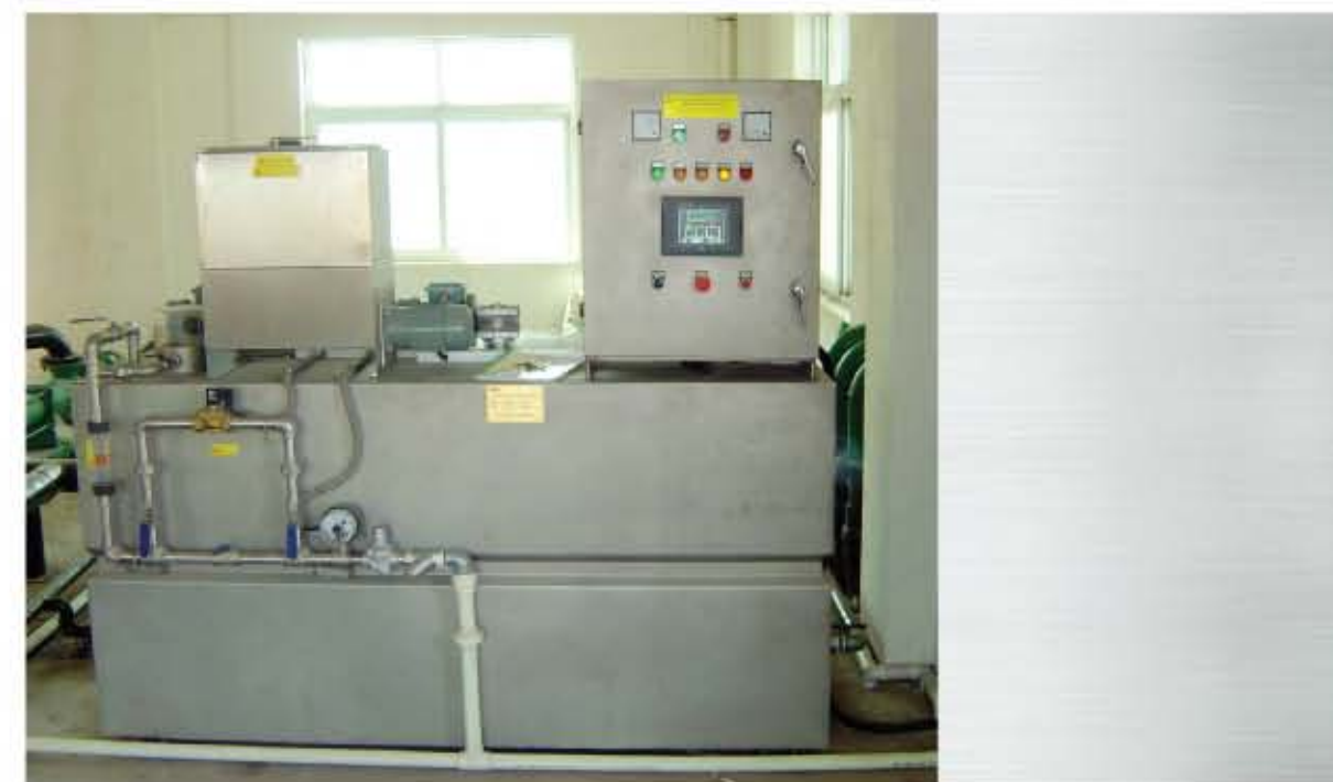
机型: PY3-3000, 处理量3m³/hr,泡药浓度0.5%
