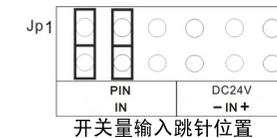
**注意：JP1 的跳针只能按以上两种方式插接，如以其它形式连接，有可能损坏电路！**
