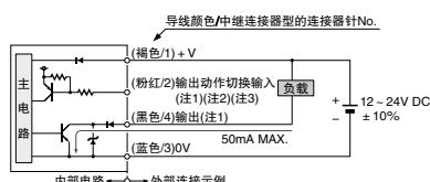
(注1): 透过型投光器不配备输出(黑/4)及输出动作切换输入(粉红/2)。
